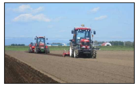
無人+有人の協調作業 先行する無人トラクタによる耕うん 追従する有人トラクタによる播種
